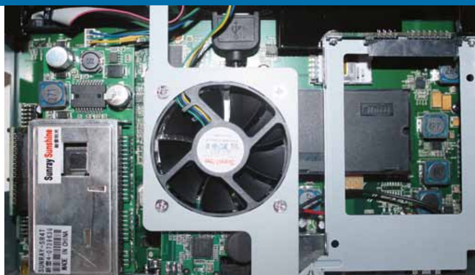
Per forza di cose l’interno del ricevitore Sunray4 è molto affollato, con una pulizia di assemblaggio esemplare, derivata dal lavoro di progettazione originale. Possiamo distinguere il grosso tuner ibrido, l’alloggiamento per un eventuale hard disk SATA interno e la ventola di areazione dalle generose dimensioni. Tutto lo spazio disponibile è occupato dalla scheda madre che ospita l’intera circuiteria, scelta possibile grazie all’alimentazione esterna. Si distingue agevolmente anche la scheda per la connessione wireless e il cavo USB, scollegato per l’attivazione del Wi-Fi
